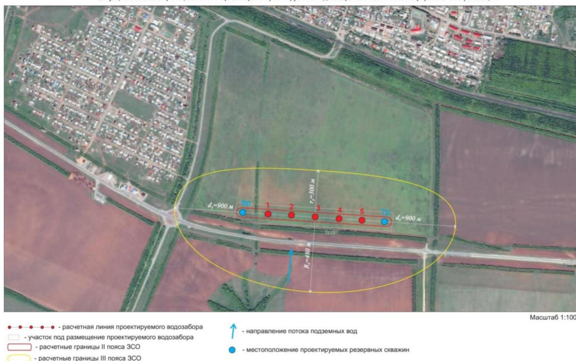
Ситуационная схема границ зоны санитарной охраны проектируемого водозабора Юго-Восточного микрорайона п. Переволоцкий
