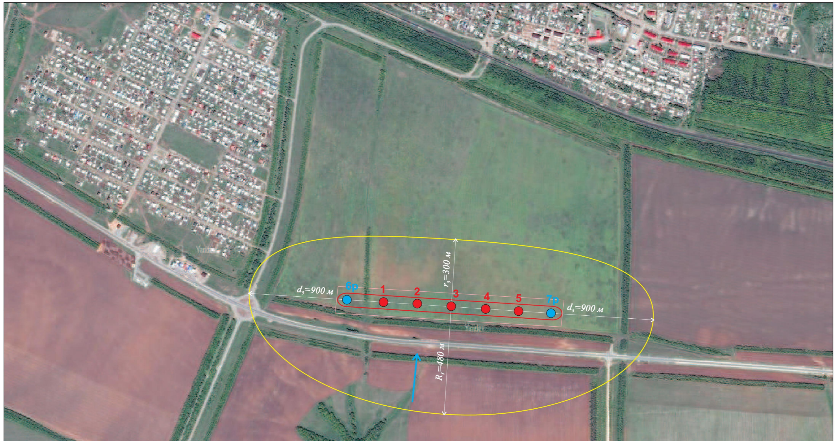
Ситуационная схема границ зоны санитарной охраны проектируемого водозабора Юго-Восточного микрорайона п. Переволоцкий
